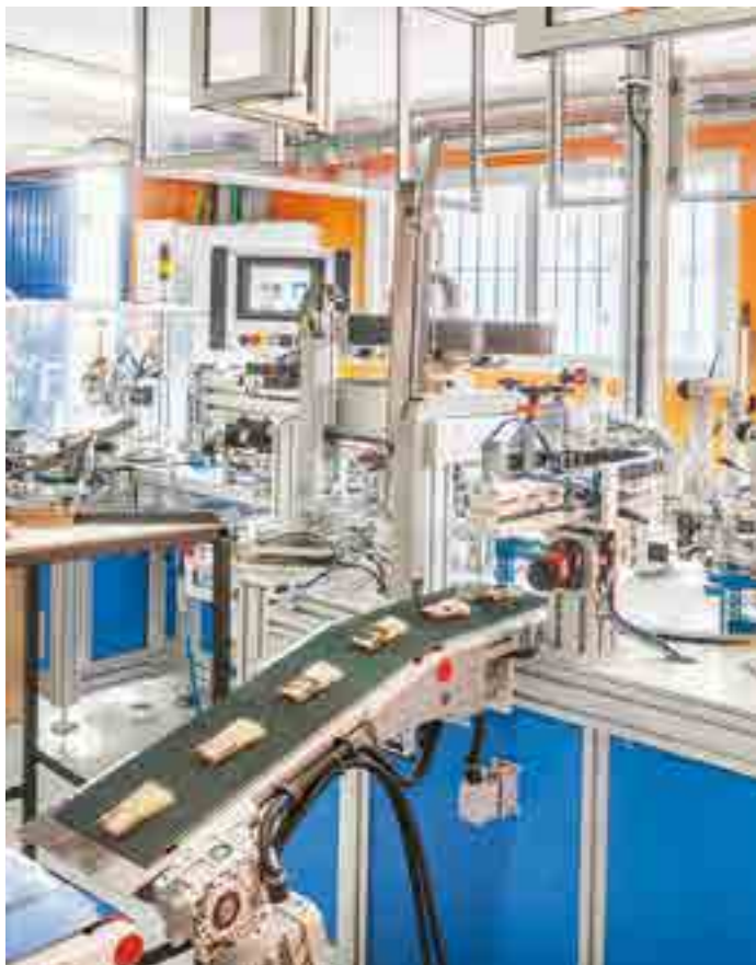
Lineas de fabricación automática de paletinas y brochas. / Linha de fabricação automática de trinchas.
