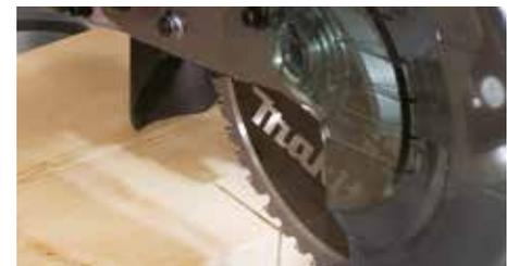
Punto de luz posicionado para indicar la línea de corte exacta.
