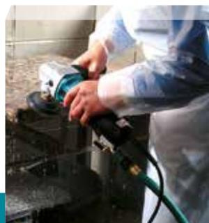
Pulido con agua de todo tipo de mármoles y granito.
