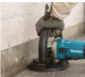
La cubierta frontal extraíble permite debastar al ras de las paredes o esquinas.
