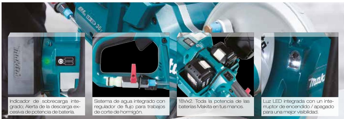
Indicador de sobrecarga integrado; Alerta de la descarga excesiva de potencia de batería.
