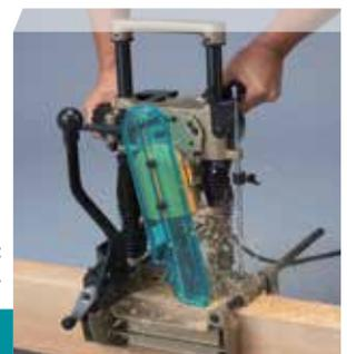
Ideal para el cajado en viga. Base adaptable al ancho de viga.
