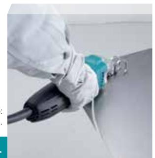
Especialmente diseñada para cortes rectos, hasta 1,6 mm en hierro dulce.
