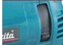
Para inversión de giro. Permite cambiar la posición de las escobillas respecto al inducido consiguiendo así más potencia y alargando la vida de las escobillas 3 veces más.
