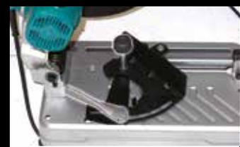
Ajuste rápido para una fijación de la pieza de trabajo.
