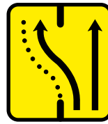
TS-61 Desvío de un carril por la calzada opuesta, manteniendo otro por la de obras
