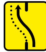
TS-60 Desvío de un carril por la calzada opuesta
