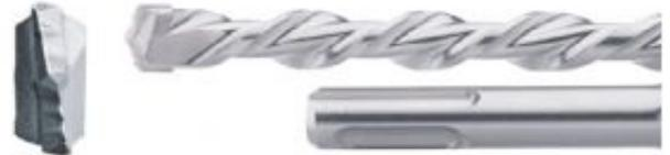
Broca de martillo SDS-PLUS para taladrar hormigón. La hoja de doble filo permite una perforación rápida. La punta de carburo de tungsteno aumenta la eficacia del trabajo. Esta broca tiene una longitud total de 160 mm, una longitud de trabajo de 100 mm y un diámetro de 10 mm.
