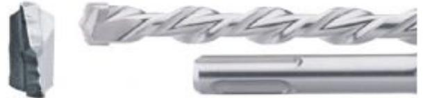
Broca de martillo SDS-PLUS para taladrar hormigón. La hoja de doble filo permite una perforación rápida. La punta de carburo de tungsteno aumenta la eficacia del trabajo. Esta broca tiene una longitud total de 110 mm, una longitud de trabajo de 50 mm y un diámetro de 10 mm.
