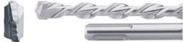
Broca de martillo SDS-PLUS para taladrar hormigón. La hoja de doble filo permite una perforación rápida. La punta de carburo de tungsteno aumenta la eficacia del trabajo. Esta broca tiene una longitud total de 160 mm, una longitud de trabajo de 100 mm y un diámetro de 8 mm.
