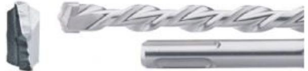
Broca de martillo SDS-PLUS para taladrar hormigón. La hoja de doble filo permite una perforación rápida. La punta de carburo de tungsteno aumenta la eficacia del trabajo. Esta broca tiene una longitud total de 110 mm, una longitud de trabajo de 50 mm y un diámetro de 6 mm.
