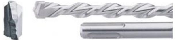
Broca de martillo SDS-PLUS para taladrar hormigón. La hoja de doble filo permite una perforación rápida. La punta de carburo de tungsteno aumenta la eficacia del trabajo. Esta broca tiene una longitud total de 110 mm, una longitud de trabajo de 50 mm y un diámetro de 5 mm.
